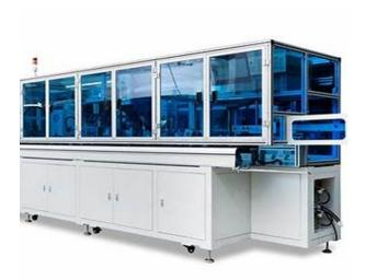
Линия сборки PV Junction Box (автоматизированная сборка) На фото — современная линия автоматической сборки диодов и корпусов для солнечных соединительных коробок (модель подобна JMTHY-ALX450) transfoindustrie.com+8
