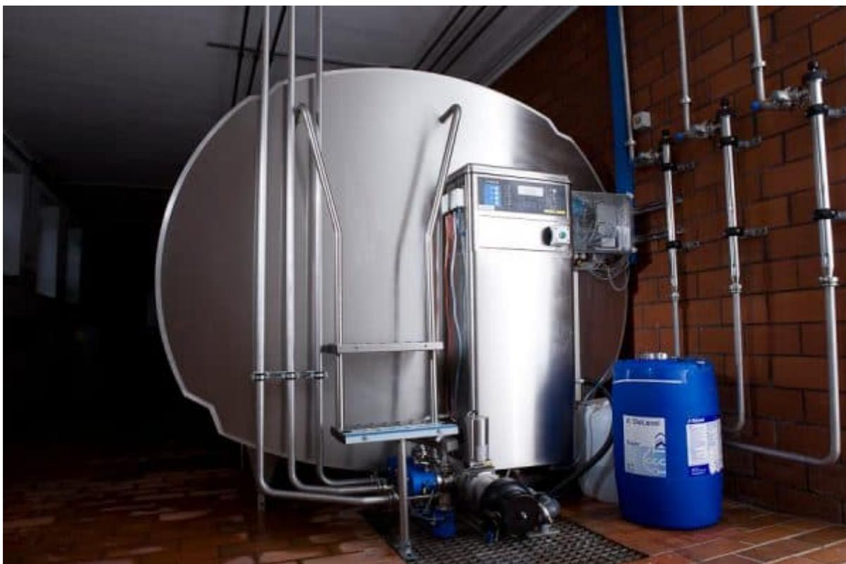
Какие нужны насосы на мини-заводе для производства пищевого молочного продукта. Пищевые насосы предназначены для перекачивания молока или густых веществ, вязкость которых составляет до 20 Пас. Агрегат для производства продукции выполнен из нержавеющей стали. Он состоит из моноблока, соединительной муфты и шланга, через который поступает молоко.
